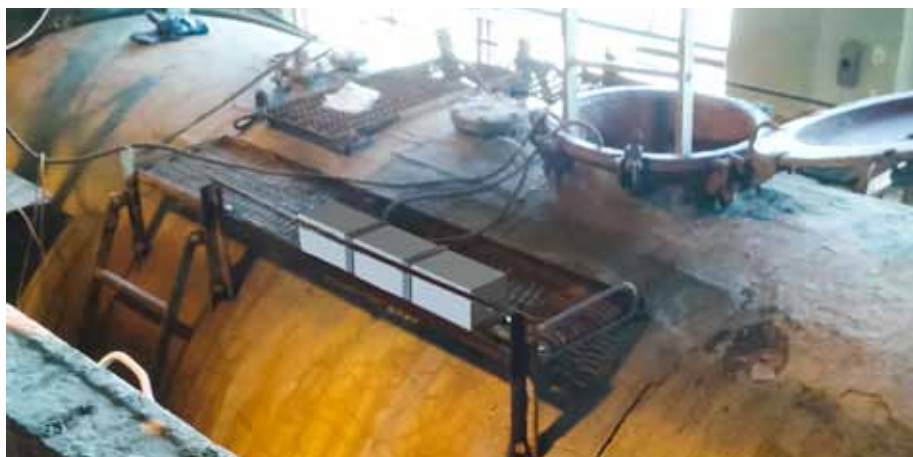
Рис. 8. Электронное ЗПУ со сроком автономной работы от 12 лет на вагоне с соляной кислотой
