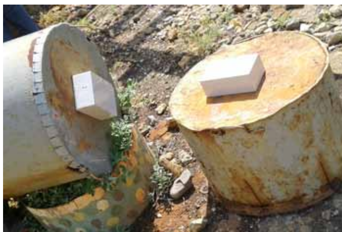
Рис. 3. Детекторы хлора на защитных колпаках цистерн
