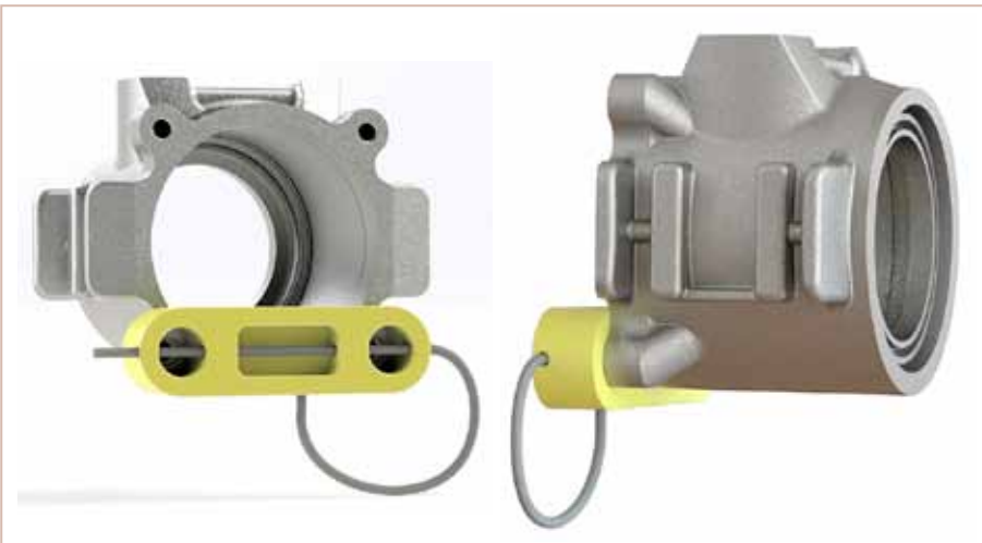
Рис. 7. Предварительный вариант проработки внешнего вида, габарита и методов крепления электронного ЗПУ на буксовом узле колесной пары
