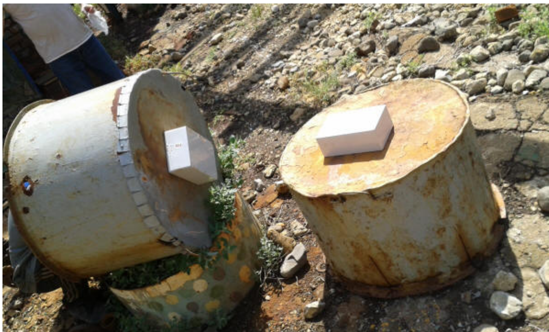
Рис. 2. Детекторы хлора на защитных колпаках цистерн.
