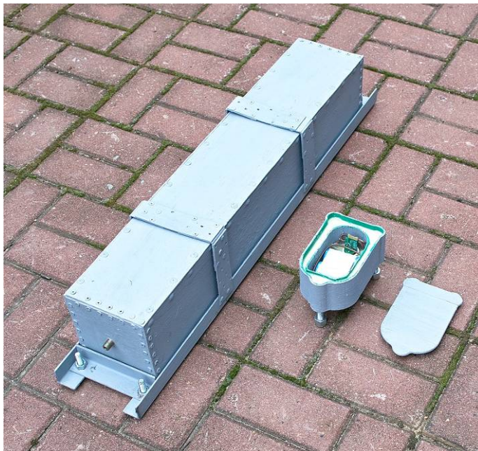
Рис. 7. Детектор утечки хлора и бортовой блок системы объективного (юридически-значимого) контроля качества и полноты предоставления транспортных услуг.
